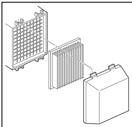
Чистка воздушного фильтра. Ослабьте винт, снимите крышку и снимите картридж фильтра. В случае засорения воздушного фильтра двигатель будет работать ненадлежащим образом и может выйти из строя. Заменяйте воздушный фильтр ежегодно или даже чаще, если вы работаете в условиях сильной запыленности. Обращайтесь к руководству по эксплуатации двигателя. (Прочитайте также прилагаемое руководство по эксплуатации двигателя.)
